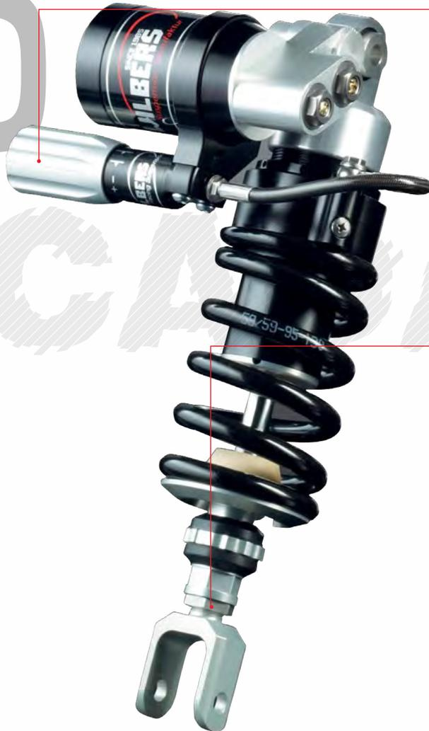
Le réglage de la précontrainte hydraulique (PA) pour ajuster l'assiette de la moto pour la compétition ou les différentes phases de chargement possible (Solo / duo / bagages) ! La plage de réglage maximale de la précontrainte du ressort est de 10 mm (toujours livré avec support).
