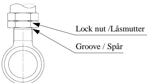
På denna modell finns en ändöglä/bygel monterad som är justerbar på längden. Öglan/bygeln får ej skruvas ut längre än att spåret blir helt synligt under låsmuttern. Se skiss. Se till att låsmuttern är fastdragen efter justering.
