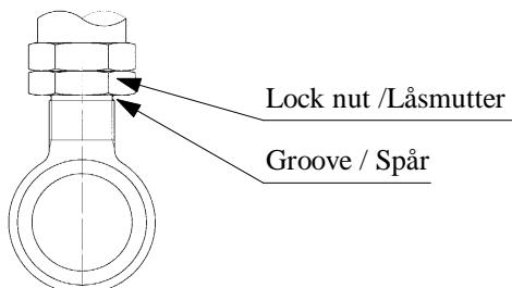
På denna modell finns en ändöglabygel monterad som är justerbar på längden.
